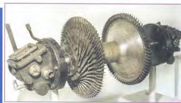
شکل ۲- توربین گازی Elling
