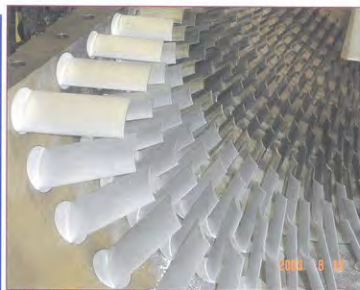
شکل ۲۵ - پره‌های نصب شده بر روی استاتور
