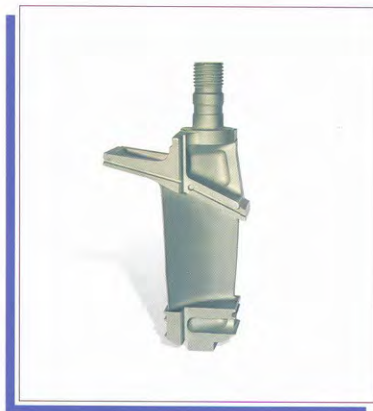
شکل ۲ - د - پره ثابت ردیف ۲ توربین قدرت (PT) - توربین گازی Ruston-EM85
