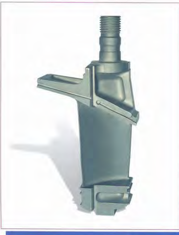
شکل ۲- الف - پره ثابت ردیف ۲ توربین کمپرسور (CT) - توربین گازی Ruston-EM85
