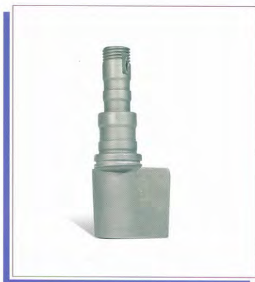
شکل ۲ - ج - پره ثابت ردیف ۱ توربین قدرت (PT) - توربین گازی Ruston-EM85
